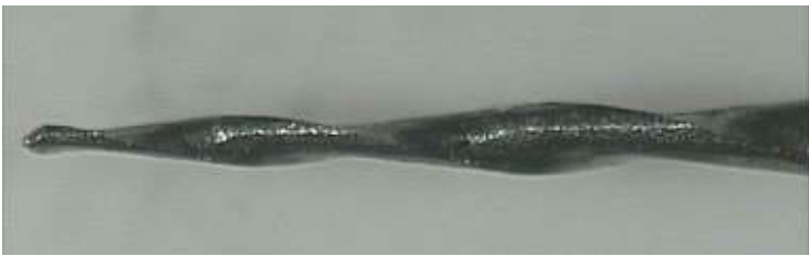
Fig. 3 Le ampie spire di un Mtwo® consentono una notevole rimozione dei detriti prodotti. Si noti la punta arrotondata.
