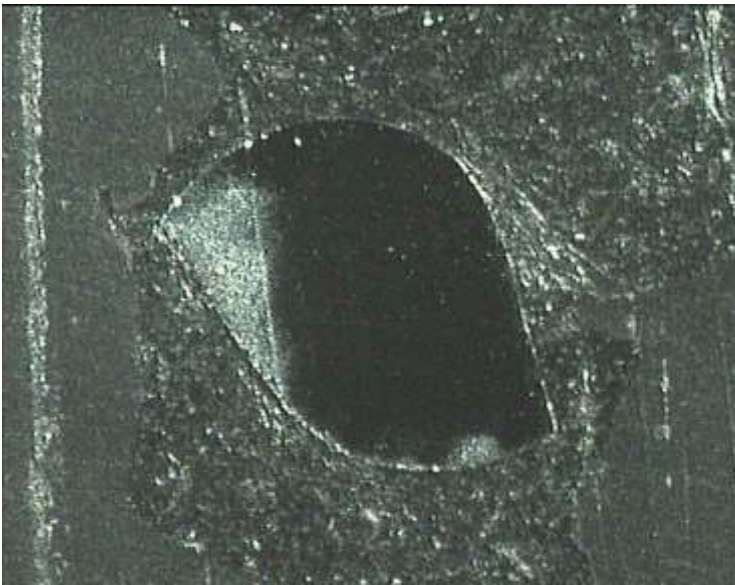
Fig. 2 Sezione di un Mtwo®: sono evidenti le due lame
